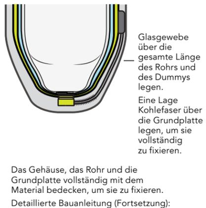
**8 Nach dem Laminieren den Dummy abschleifen.**
