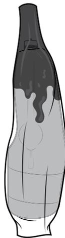
11 Wenn Sie eine zweistufige Laminierung durchführen, übertragen Sie jetzt die Ausrichtung der Muffe.
